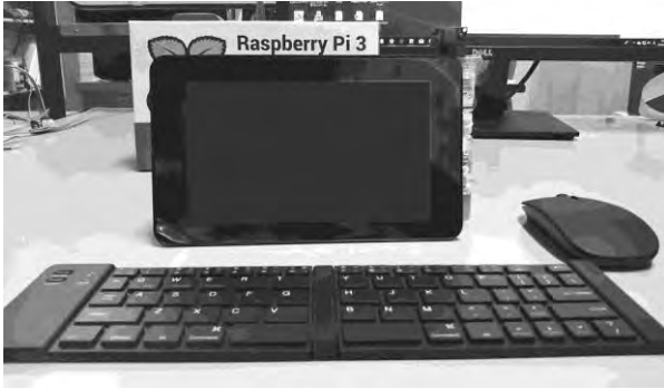
図1 本教材のインターフェース (Raspberry Pi 本体はディスプレイの裏に固定)
