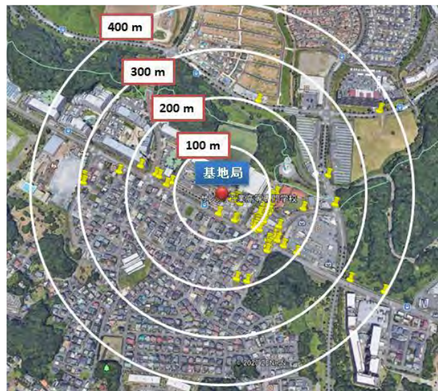
図 3 LoRaカバレー調査結果
