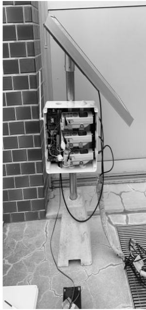
図1 製作した塩分濃度観測ノード
