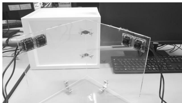
図1. ステレオ計測システム
