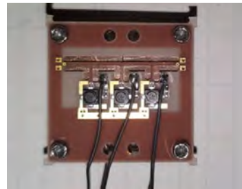
図 2. 4.5 GHz/28 GHz 帯 2次元切替スイッチの写真
