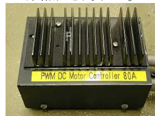
(写真.3) モーターコントローラー
