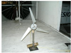
風車システムにおいて最も重要とされる問題のひとつは、風の持つ運動エネルギーをいかに有効に機械的エネルギーに変換できるか、というところにある。風車の回転にブレードがどう影響してくるのかを、ブレードの大きさ、枚数、とり付け角(ピッチ角)を変化させたときの発電量を測定して比較していく。
