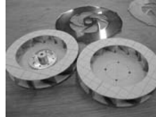
図3 試作した遠心ファン
