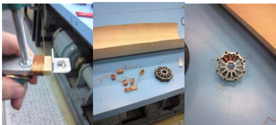
図1 鉄心にコイルを巻く様子
