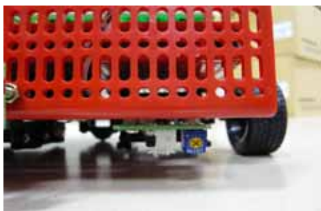
図1 アナログ赤外線センサ ・ギアボックス RDO-501 (2個使用) ロボットの動力機構として使用する。
