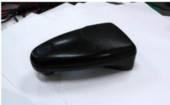
図 1. 色彩計:CS-CM1000(凸版印刷社製)
