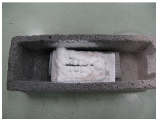
図 1 焼結後に形成された酸化皮膜
