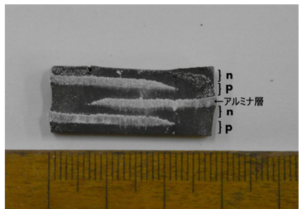
図2 短冊型 FeSi 2 積層デバイスの焼結体
