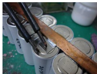
図 2 スポット溶接
