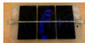
図2 太陽光パネル
