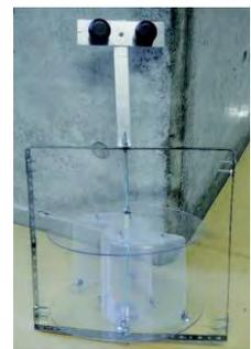
(a)ダブルデルタボックスカイト (b)サボニウス型風車
