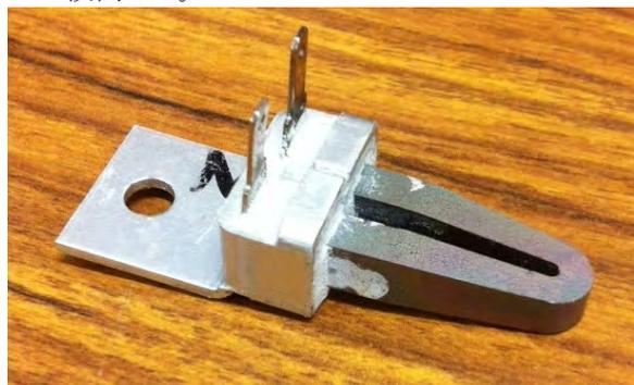
図1 Fe-Si系サーモモジュール
