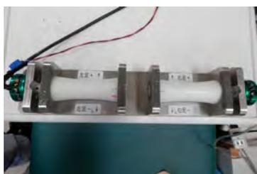
図3. 脚長変化測定器
