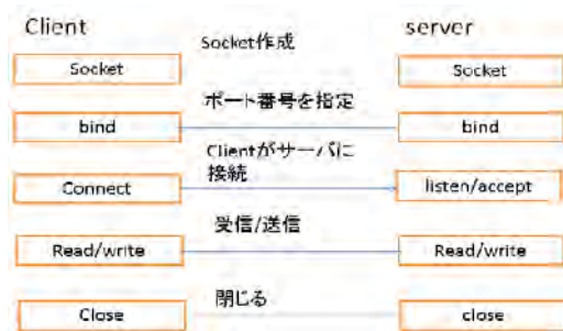
図 1. ソケット通信の Client と server の役割
