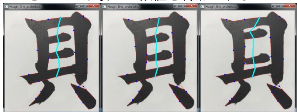
図1 横画が重なる文字にハフ変換を用いた結果
