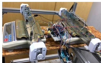
図 1 ステッピングモーター設置後の模型位置出し部
