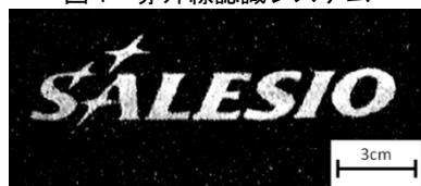
図2 セキュリティインクの赤外発光の様子
