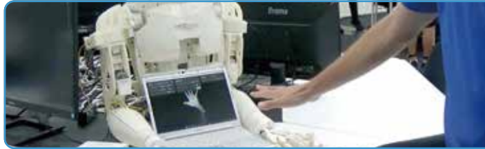
Leap Motionで読み取ったユーザーの指の動きを トレースする3Dプリンタで出力したロボット
