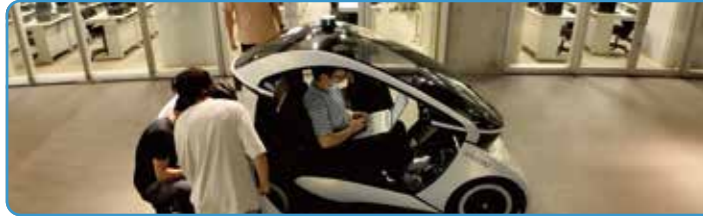
卒業生を介した産学連携によるLiDAR等各種 センサーを駆使したオリジナル自動運転EV「VISMO」
