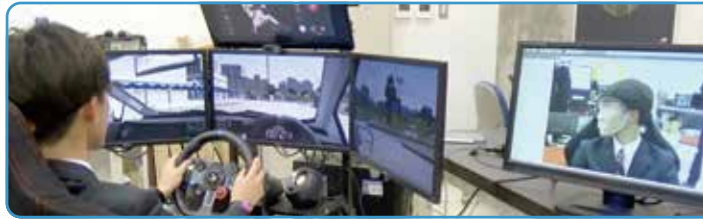
ドライビングシミュレーターを用いた AIによる運転者の表情解析&モーションキャプチャー
