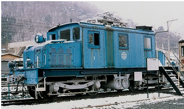
図8 独国製アプト式10000形（後のEC40形）電機
