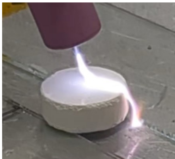
図 3 プラズマ処理の様子
