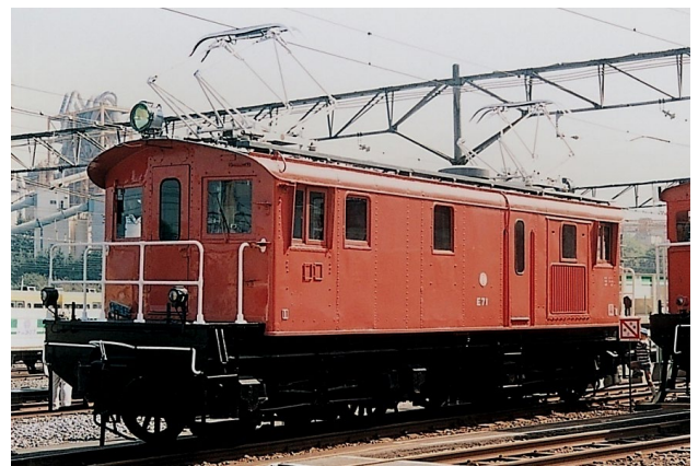
図11 米国製1000形（後のED10形）電機
