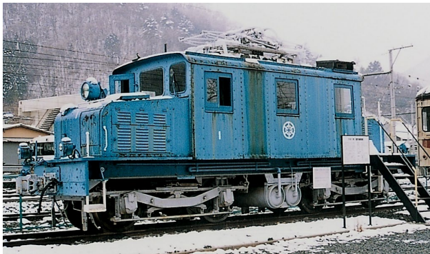
図8 独国製アプト式10000形（後のEC40形）電機
