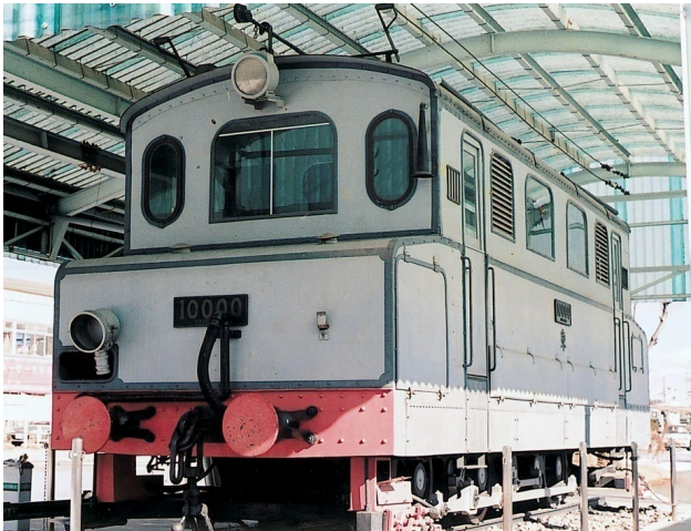
図8 独国製アプト式10000形（後のEC40形）電機
