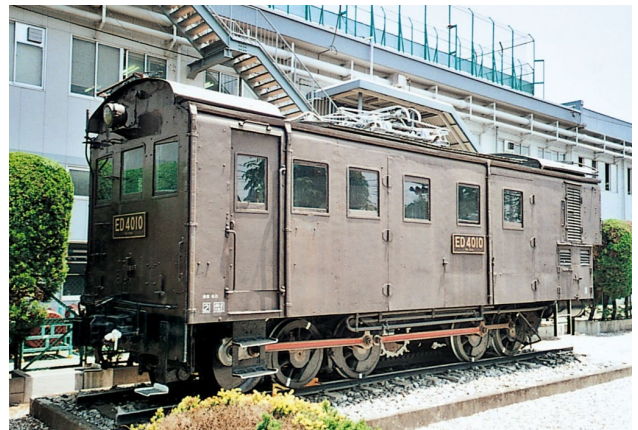
図9 国産アプト式10040形（後のED40形）電機
