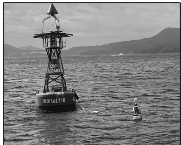
図 9 観測ノードブイの設置状況
