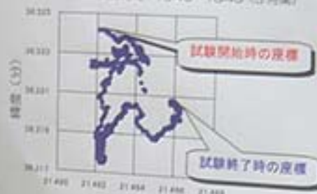
図1 単独測位試験（静止）
