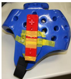
図 2-1. Wii リモコンを装着したヘッドギア
