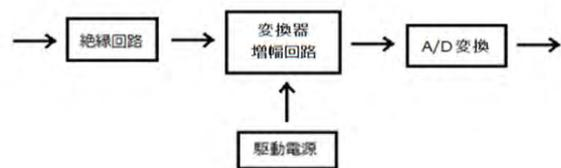
図3 電流センサ回路のブロック図
