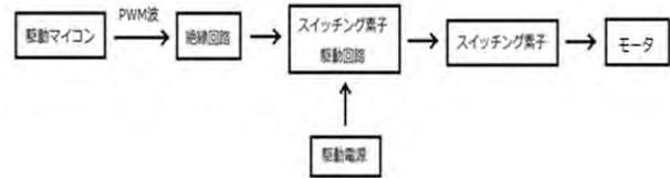
図2 ドライブ回路のブロック図
