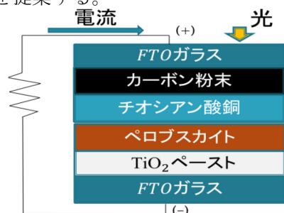
Fig. 1 ペロブスカイト太陽電池の簡単断面図
