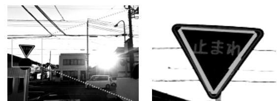
図 2. 提案手法による標識検出結果
