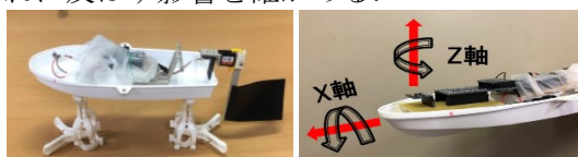
図1 ヒレ型推進機構
