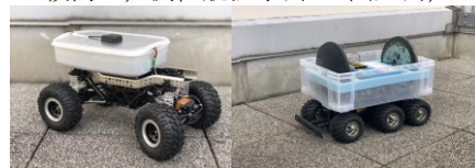
図1 マシンの外観（左：4輪車体，右：6輪車体）
