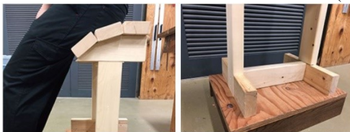
図 1 試作による傾斜角度の調整(左)、座面の高さ(右)
