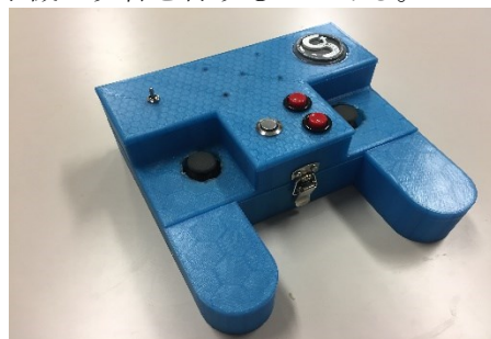
図2 コントローラの筐体
