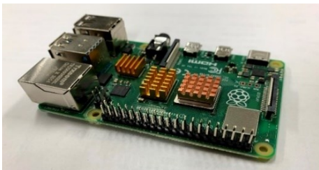
図 1 Raspberry Pi 4 model B
