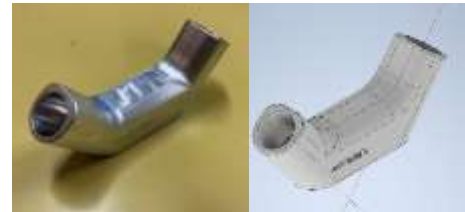
図 3 設計データ(左)と実際に製作した部品(右)
