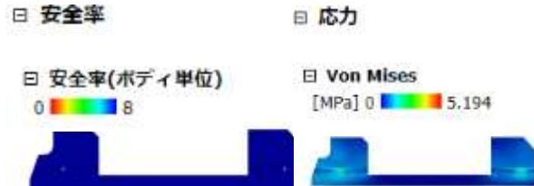
図 1 安全率(左)と応力(右)の解析データ
