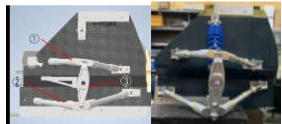
①アッパーアーム ②ロアアーム ③アップライト 図 4 実際に組付けた様子
